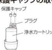
新しい浄水カートリッジの上端プラグに付いている保護キャップを取り外してください。（2ヶ）
